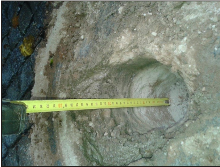
Fot.5. Międzygórze. Droga nr 3232D. Otwór nr 1. Pod 5 - 7 cm warstwą kostki granitowej stabilizacja piaskowo-cementowa h = 15 cm.
