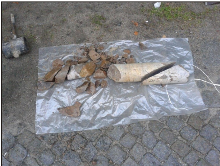
Fot.13. Międzygórze. Droga nr 3232D. Wydobyty rdzeń z otworu. Rdzeń D-112mm z ukośnym pęknięciem. Rdzeń D-82 mm uzysk 100% w kawałkach.
