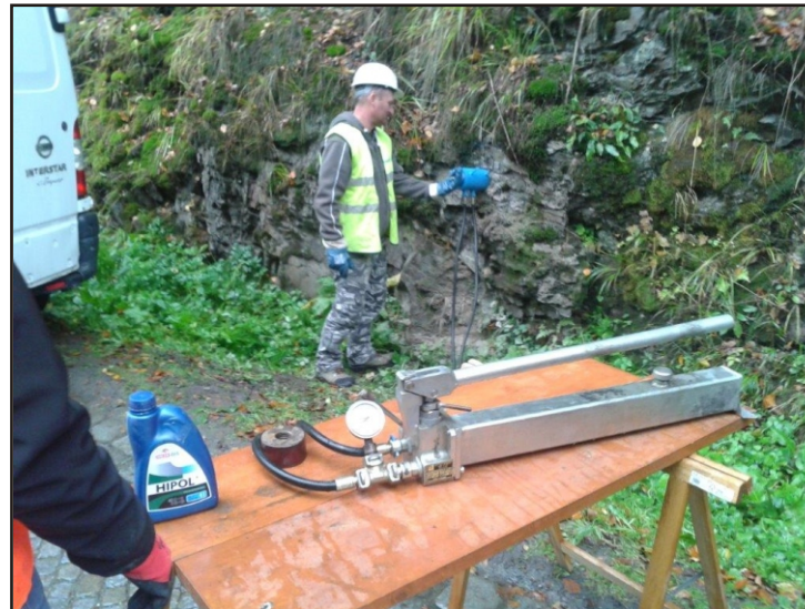
Fot.14. Międzygórze. Droga nr 3232D. Stanowisko pomiarowe stopnia sprężenia górotworu.
