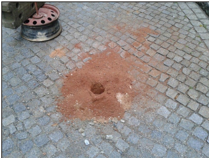
Fot.7. Międzygórze. Droga nr 3232D. Otwór nr 4. Głębokość 0,30-1,5m. Zwiercony odcinek stropu gnejsu płytowego.
