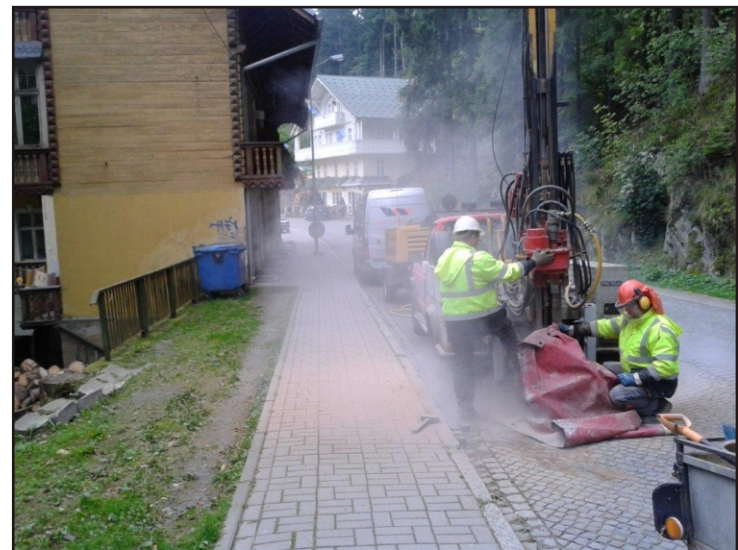
Fot.8. Międzygórze. Droga nr 3232D. Otwór nr 5. Wiercenie udarowe. Pobór prób zwierconej skały z głębokości 4,0 m p.p.t.. Otwór badawczy zlokalizowano w rejonie niszy osuwiska.
