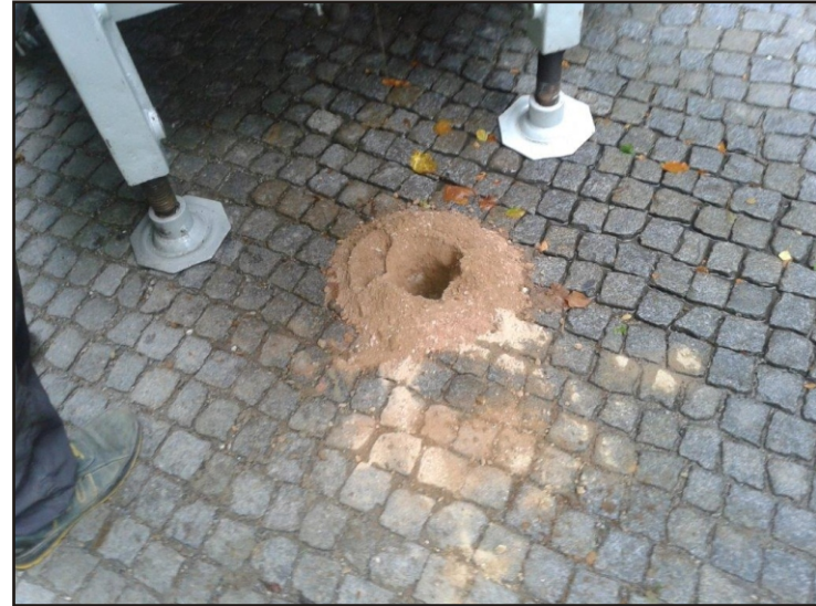
Fot.6. Międzygórze. Droga nr 3232D. Otwór nr 1. Głębokość 15-50 cm. Warstwa podbudowy z kruszywa łamanego barwy ciemnożółto - szarej.
